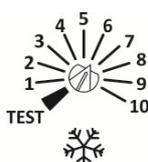
Устанавливает порог срабатывания датчика осадков. 1 = макс. чувствительность, 10 = мин. чувствительность. Крайнее левое положение активирует режим «ТЕСТ» датчика осадков.
